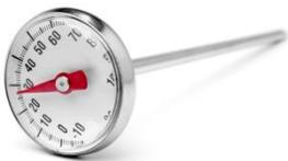
Uno de los termómetros más comunes es el termómetro bimetalico instantáneo (termómetro de bolsillo). Estos termómetros son económicos, fáciles de usar, y muy exactos si son calibrados frecuentemente. Regularmente, se toma entre 15 y 20 segundos para obtener una temperatura exacta al usar este tipo de termómetros.
