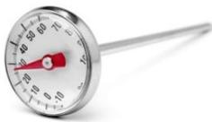
Uno de los termómetros más comunes es el termómetro bimetalico instantáneo (termómetro de bolsillo). Estos termómetros son económicos, fáciles de usar, y muy exactos si son calibrados frecuentemente. Regularmente, se toma entre 15 y 20 segundos para obtener una temperatura exacta al usar este tipo de termómetros.
